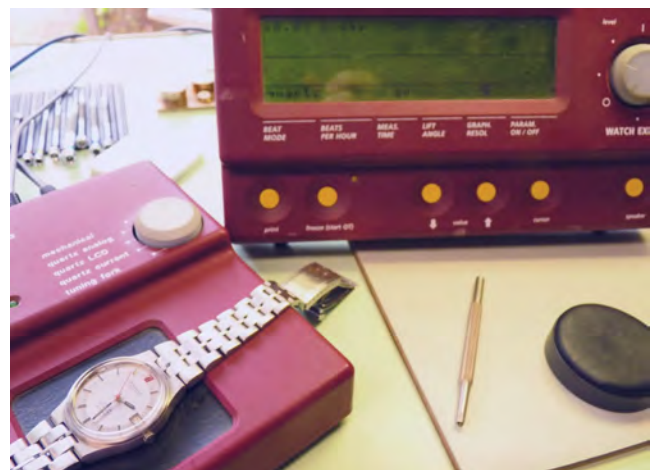
meten met het afregelapparaat
