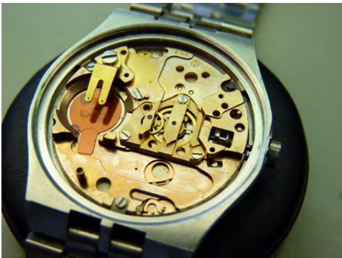
uurwerk in de kast, moduul gedemonteerd
