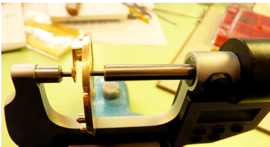
bepalen van de totale lengte van de balansas, door de hoogtemaat tussen platine en kloof op te meten
